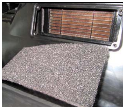
obr. 263: Montáž filtru čerstvého vzduchu
