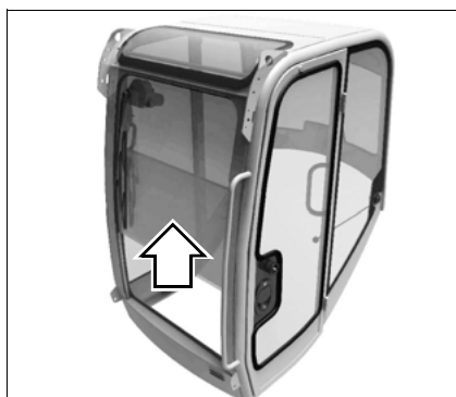
obr. 82: Dolní část čelního okna
