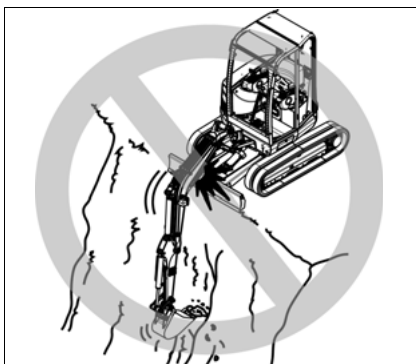
obr. 201: Práce na svazích
