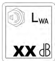
Obr. 23: Hladina akustického výkonu
