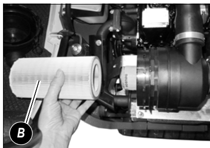
obr. 149: Demontáž vnějšího vzduchového filtru
