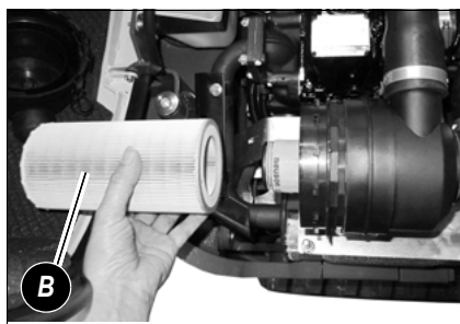
obr. 151: Demontáž vnějšího vzduchového filtru
