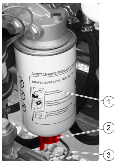
Obrázek 68: Odvodnění palivového filtru
