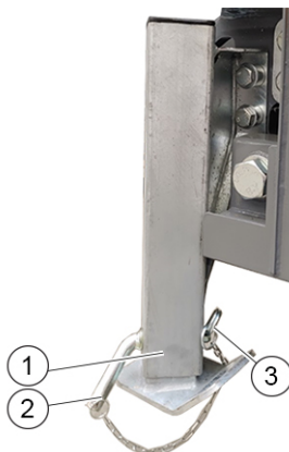
Obrázek 30: Opěrná patka (jsou možná různá provedení)
