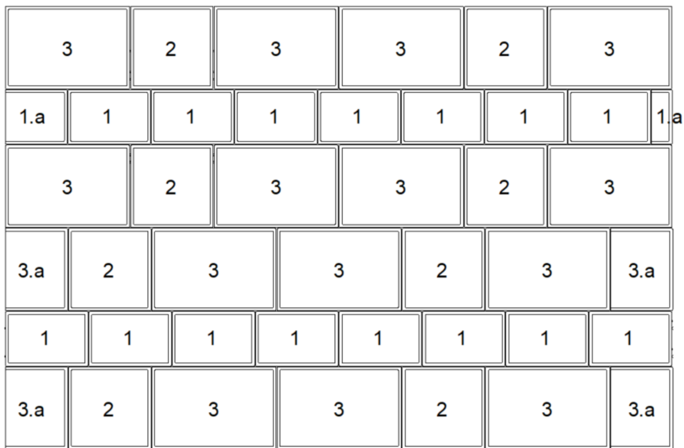
Obr. 2 – Návrh skladby položení dlažby Moravský Granit
