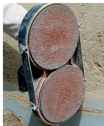
Agresivní broušení pomocí kotoučů z tvrdokovu
