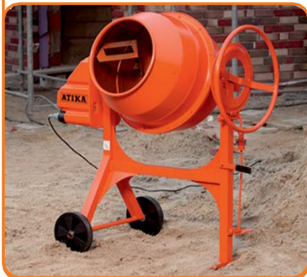
bezpečná obsluha díky ručnímu ovládacímu kolu s nožní brzdou
