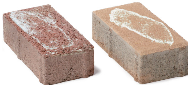
Dlažba s výkvětem
